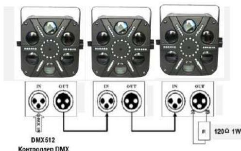
Если сигнальная линия слишком длинная, или при установке в помещениях с относительно высоким уровнем электрического шума (например, караоке или дискотека), рекомендуем использовать терминатор DMX (цепное соединение). Благодаря ему можно избежать помех в цифровом сигнале. Терминатор DMX состоит из простого соединительного разъема XLR (2-pin и 3-pin), подключаемого к резистору 120 Ом. Вставьте его в гнездо DMX-выхода последнего устройства в цепи. См. рисунок ниже:
