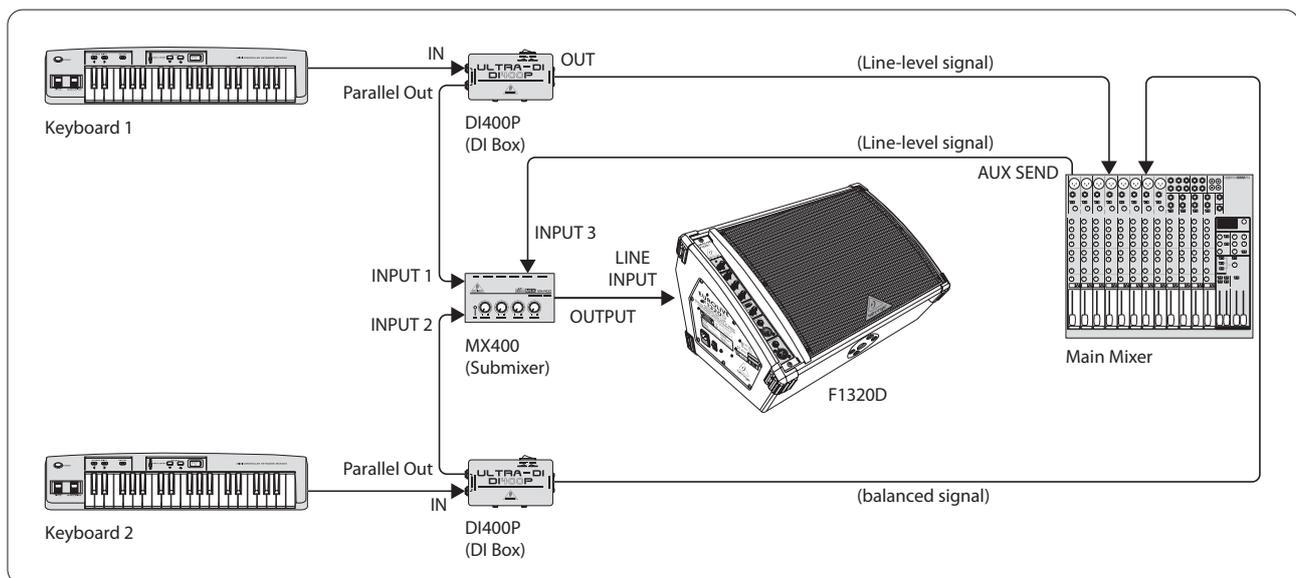
Рис. 3.1: F1320D с двумя клавиатурами
